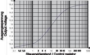
Steuerwiderstand nach E96-Reihe Ausgangsspannung SNT12512
