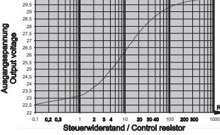
Steuerwiderstand nach E96-Reihe Ausgangsspannung SNT12524
